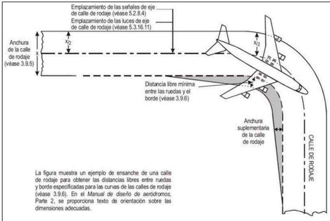
Figura C-2. Forma de ensanchar las calles de rodaje
