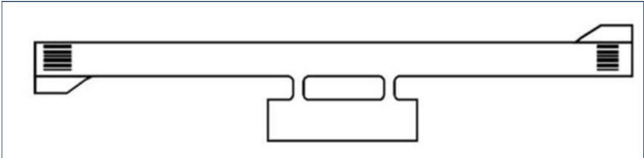
Figura C-1. Configuración de una plataforma de viraje típica
