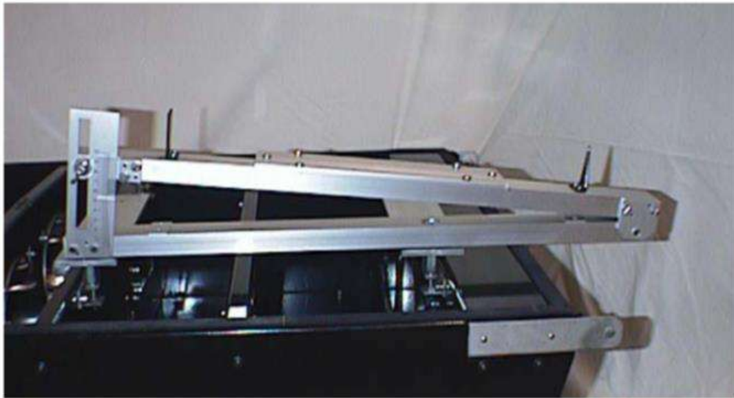
Figura 2-8-1. Detalle del elemento de ajuste del ángulo de la unidad PAPI
