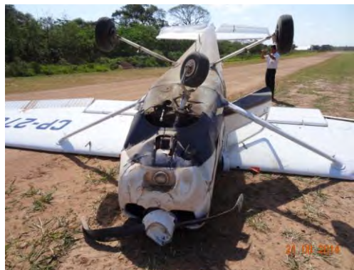
Aeronave con las hélices doblados y el tren de nariz dañado
